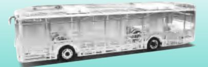
**Sécurité globale de la structure - Sécurité de la carrosserie assurée en cas de collision :** avec un châssis de l'ensemble d'autobus conçu dans la structure en boucle fermée en diamant et un profil de contrainte principal en acier léger à haute résistance (la résistance à la traction atteint 750-880 MPa), la carrosserie est plus solide et plus sûre.
